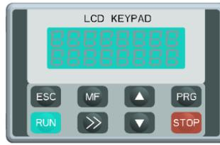
液晶显示屏可显示变频器的状态、参数及其内容、故障、报警代码、文字提示信息等。根据变频器的状态，液晶显示屏的右上角有相应的图标显示，各个图标的含义如下表：
